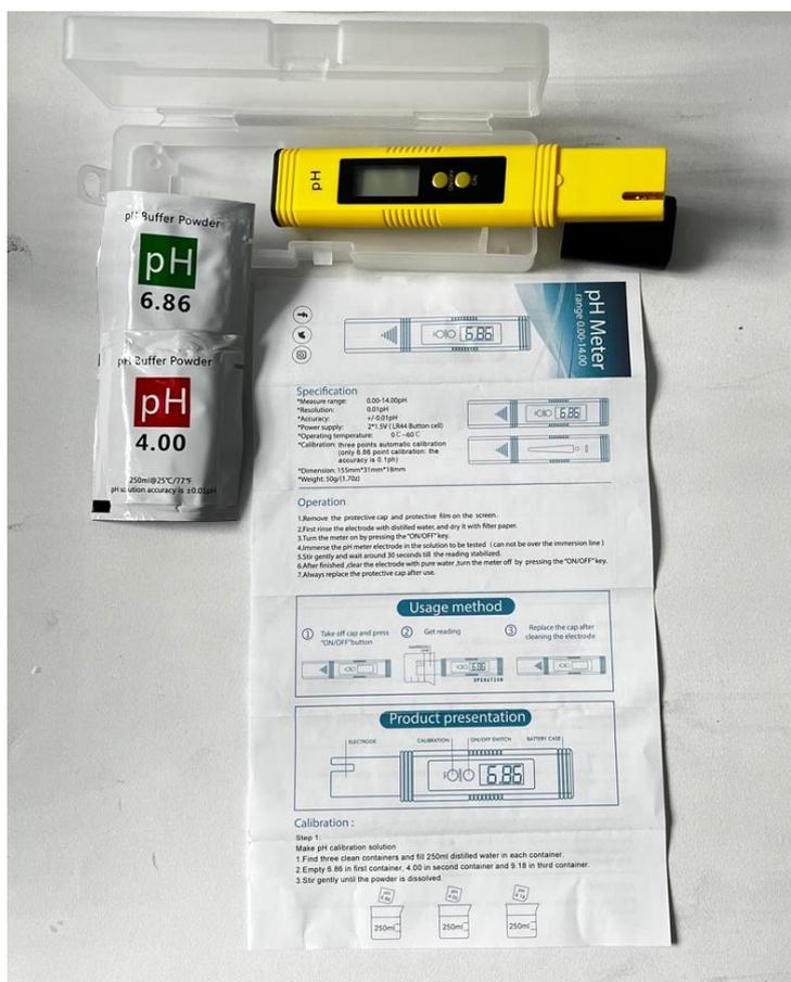
Рисунок 4 – Карманный рН-метр, стандарт-титры для приготовления буферных растворов и инструкция к рН-метру
